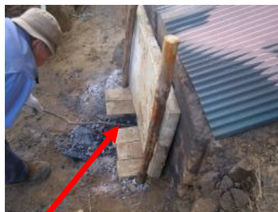
空気孔としてレンガ1個分を開ける
