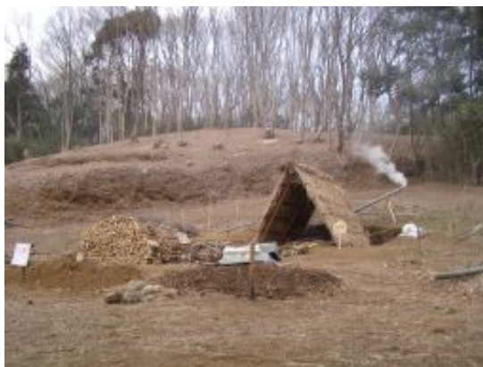
第 1 回燃焼・窯止め 窯口も煙突の穴も封鎖 煙突出口の温度が 300℃を超えて窯止め
