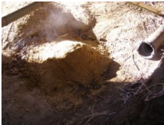
第 1 回燃焼・窯止め 窯口も煙突の穴も封鎖 煙突出口の温度が 300℃を超えて窯止め
