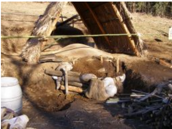
第 1 回燃焼・窯止め 窯口も煙突の穴も封鎖 煙突出口の温度が 300℃を超えて窯止め
