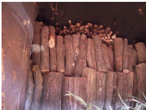
炭材投入、2段積み
